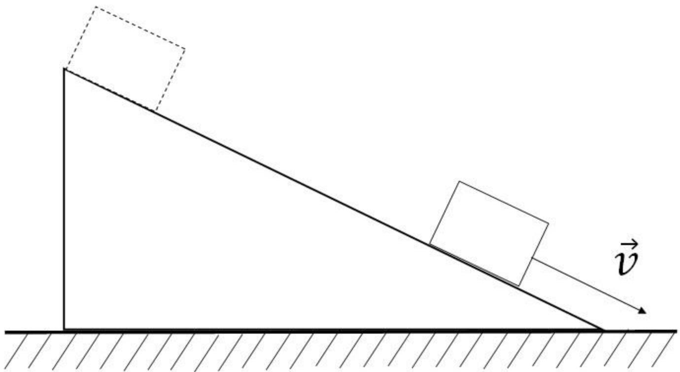
Путь, пройденный телом при прямолинейном равноускоренном движении, вычисляется по формуле:  $S=v_0t+\frac{at^2}{2}$
